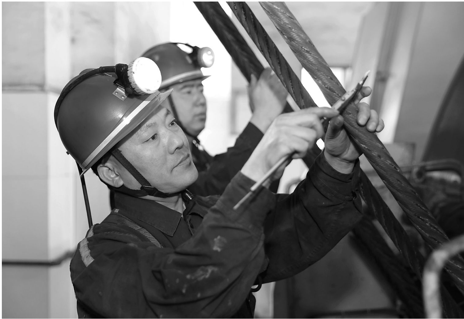
近日，安徽淮北矿业集团桃园矿全面排查整改矿井重大风险隐患。图为该矿职工对副井提升机进行验收检查。
